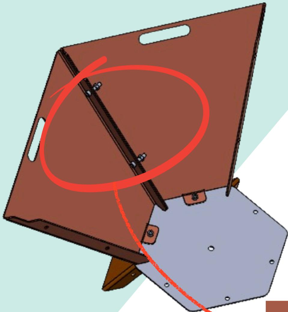
Comme l'étape précédente, venir positionner la partie haute et la partie basse sur la plaque du fond et les deux parties hautes ensemble en utilisant des vis M8 et des écrous
