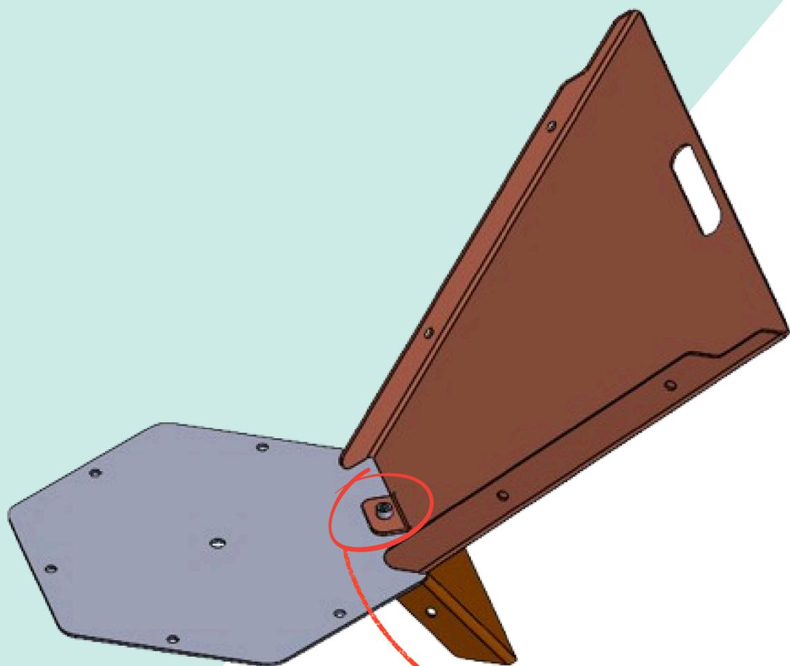
Venir positionner la partie haute et la partie basse sur la plaque du fond en utilisant une **vis M8** et faire quelques tours seulement avec l'**écrou**
