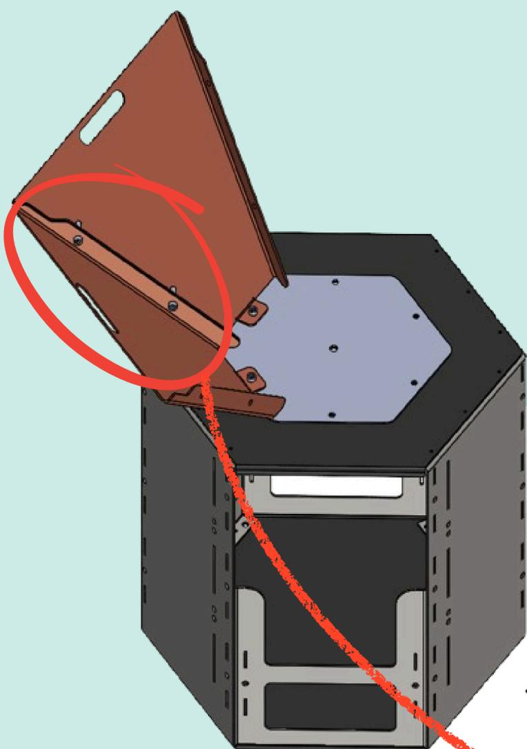
De la même manière que l'étape 2, venir positionner la partie haute sur la plaque du fond et les deux parties hautes ensemble avec des **Vis M8 et des écrous**
