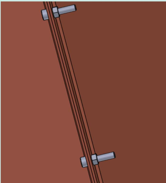
Visser les **écrous** en utilisant la **clef de 13** et la **clef BTR**
