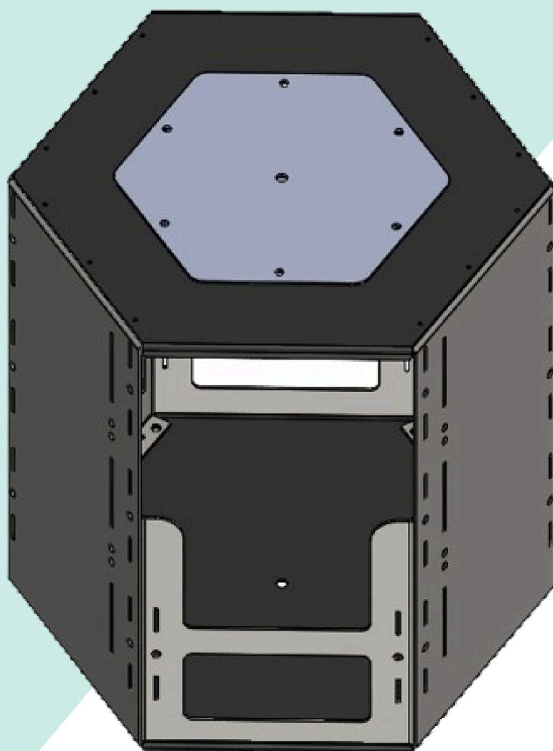
Venir positionner la plaque du fond avec le châssis. Il faut que les trous de passages de la **plaque du fond** et du **châssis** correspondent
