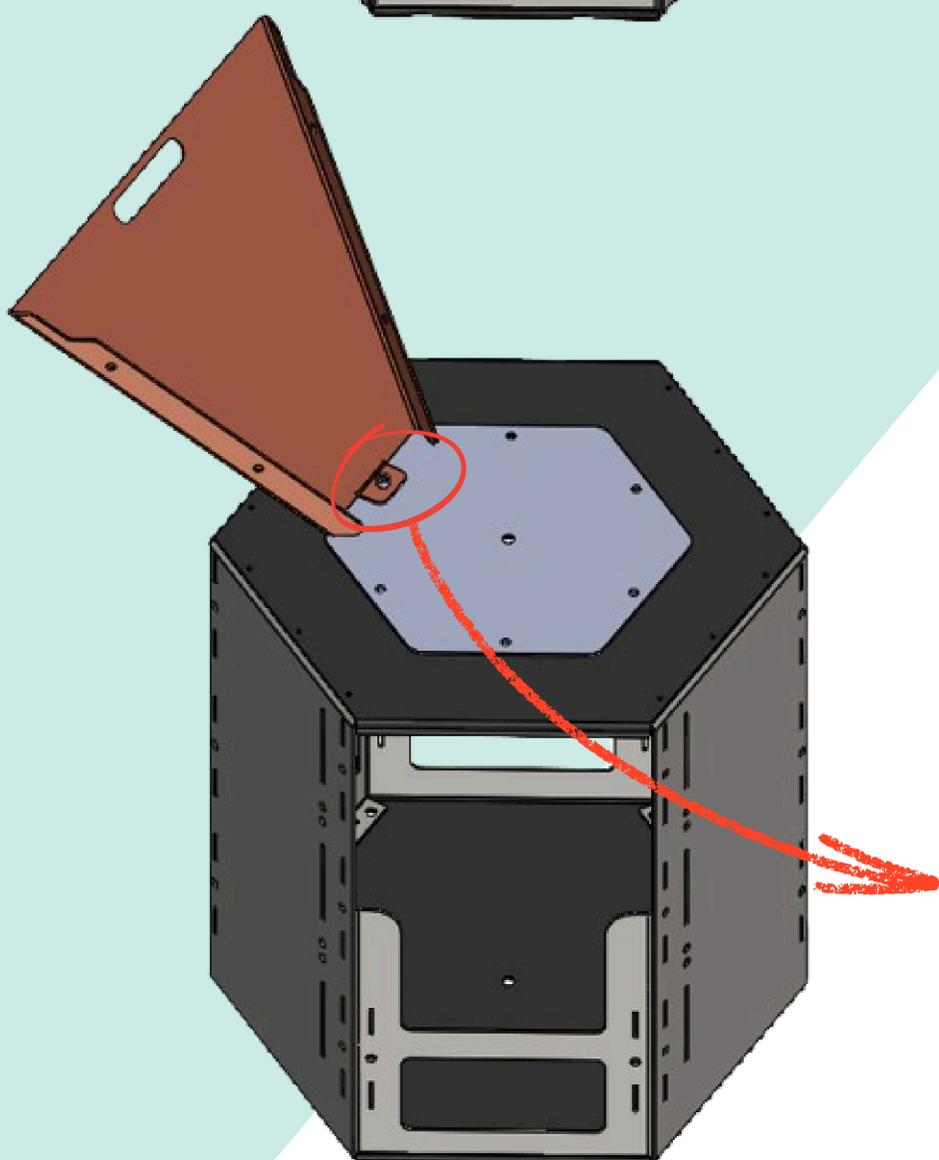
Positionner la partie haute sur la plaque du fond avec une **vis M8** et faire quelques tours seulement avec l'**écrou**
